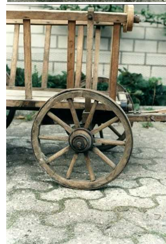
▲ Ein Bollerwagen aus längst vergangener Zeit, Baujahr ca. 1900 bis 1920. Zum Bau des Wagens kam Eichenholz zur Verwendung. Auch die Speichenräder sind ganz aus Holz hergestellt und mit Eisen beschlagen.
