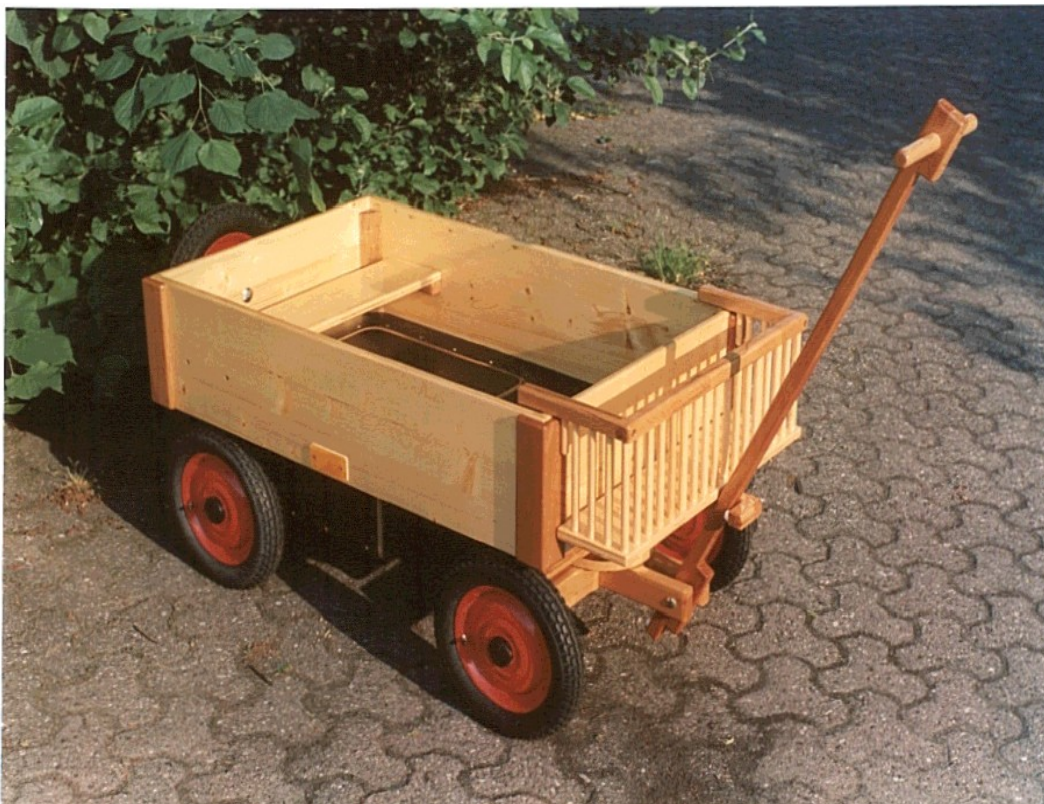
◀ DK/HD 25/100 SVKL mit Rad Nr. 3, Kleinteile-Korb, eingesteckter Sitzbank und montierten Sicherheits-Reflektoren. Lackiert.
