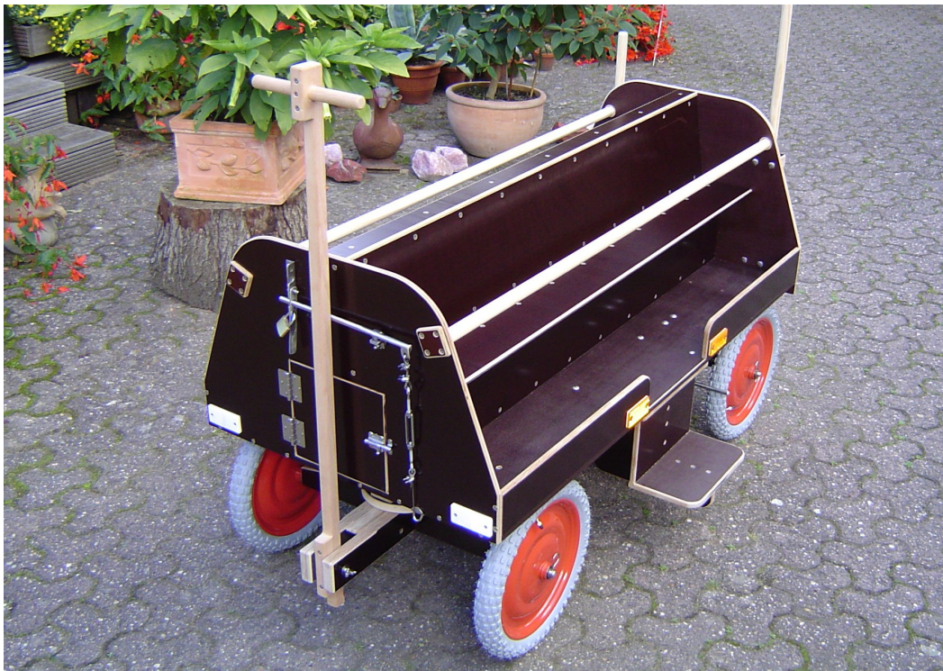
▲ Modell K, Typ: 80/150 SVK (alt), mit Sicherungs-, Schub- und Halte-Stangen, (Feststell-Bremse entfällt!), ohne Lackierung, z.Z. kein Foto vom Wagen mit Trommelbremse verfügbar, es kommen die Räder Nr. 12K + 13KB oder 15 + 16B zum Einsatz.
