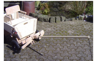
↑ HD2 Hundedeichsel mit 2 Ortscheit für 2 Hunde, ohne Lackierung, am D 30/100 SV mit Bremse und Kutschbock. Holm hier aus Buche.
